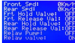
Paso 1 : seleccione " ECU_ABS DATA " Paso 2 : Presione el botón ( ← ) o ( → ) Para mostrar especific. ABS
